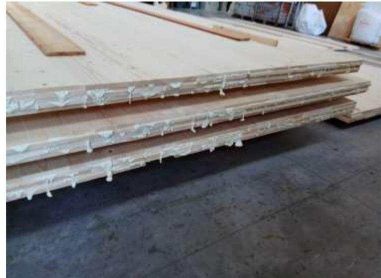
STRUTTURA DEL MODULO ECO SARA' IN LEGNO SISTEMA XLAM – PANNELLI REALIZZATI IN FABBRICA
